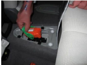
Imatge 2: Retirada del dispositiu de desconnexió.
