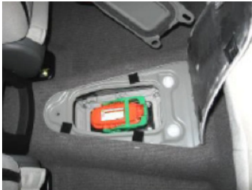
Imatge 1: Dispositiu de desconnexió de la bateria d'un vehicle elèctric en posició normal.
